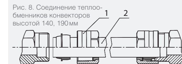
Рис. 8. Соединение теплообменников конвекторов высотой 140, 190 мм: 1 — медная труба (ø18 и толщиной 1 мм), 2 — фитинг с эластичным уплотнением ø18 мм, или с уплотнительным кольцом ø18 мм
